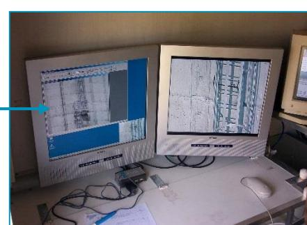
Le dispositif se présente sous la forme d'un équipement informatique transportable dans un camion laboratoire aménagé, relié à une tête d'inspection SCANSITES® pilotable à distance, depuis le camion. La tête d'inspection SCANSITES® est composée d'une monture motorisée, d'une caméra vidéo CCD et d'une optique de grossissement variable selon les applications (de 70 à 4000 mm).
